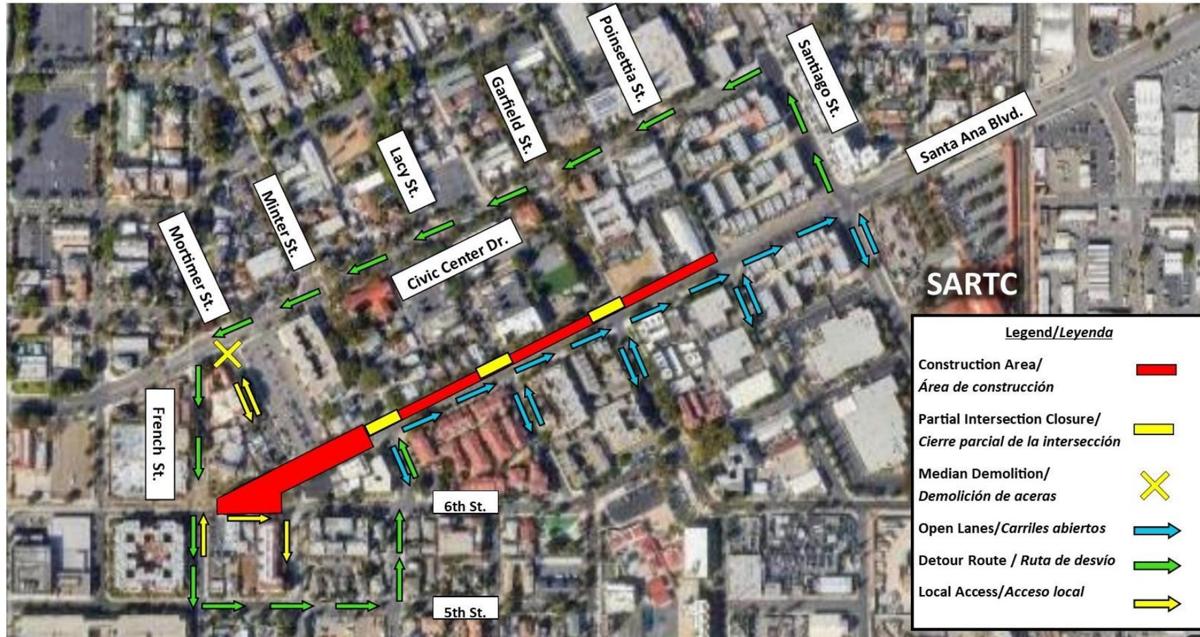
Construcción en el lado norte de Santa Ana Blvd. desde Poinsettia St. hasta Minter St. El tráfico en la dirección este se traslada al lado sur de la calle. El tráfico en la dirección oeste desviado.
